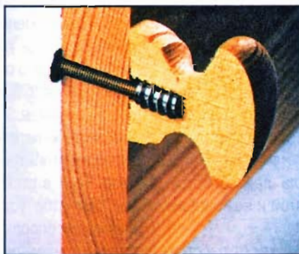
Резьбовая втулка с внутренней резьбой М4 держится в древесине мягких пород прочнее, чем шуруп.
