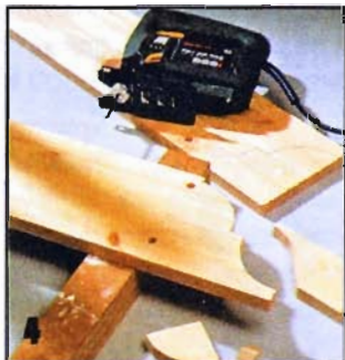
4 Фигурные профили боковых стенок выпиливают электролобзиком.
