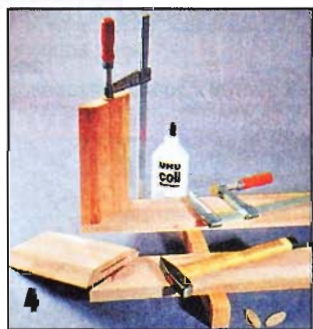
4 Прежде всего наружные детали ножек склеивают с короткими (торцевыми) деталями рамы.
