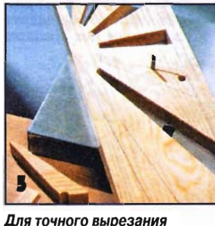
5 Для точного вырезания прорезей в фризе электролобзик лучше закрепить стационарно в приспособлении пилкой вверх. Отверстия под пилку лобзика сверлят предварительно.
