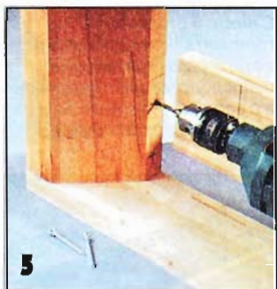
5 Еще до крепления царг (на шпонках) в деталях ножек сверлят отверстия под резьбовые стяжки.
