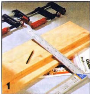
1 Мебельные щиты толщиной 19 мм прочно зажимают в пакет и с помощью столярного угольника размечают полки и крышку.
