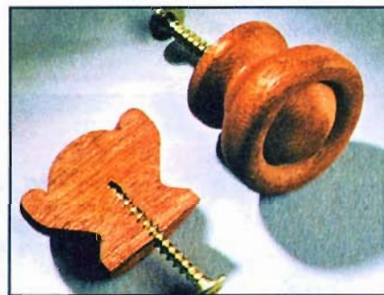
Деревянные ручки-кнопки можно крепить шурупами, если они вворачиваются поперек волокон древесины. Большая головка шурупа позволяет обходиться без шайбы.
