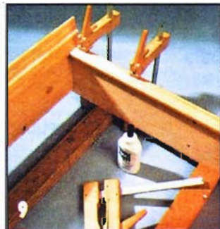
8 Пилыстры подгоняют под карниз шлифовальной шкуркой и приклеивают к торцам боковых стенок заподлицо с их наружной плоскостью, после чего зажимают струбцинами.
