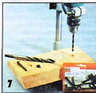
7 Перед сборкой боковых элементов рамы в наружных деталях ножек сверлят отверстия под соединительные болты М6х50 и гайки.
