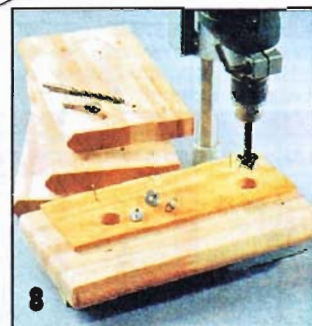
8 С тыльной стороны средней детали ножки сверлят отверстия большего диаметра под мебельные резьбовые втулки. Сверлят отверстия в два приема — сначала тонким сверлом, а затем рассверливают до нужного размера.
